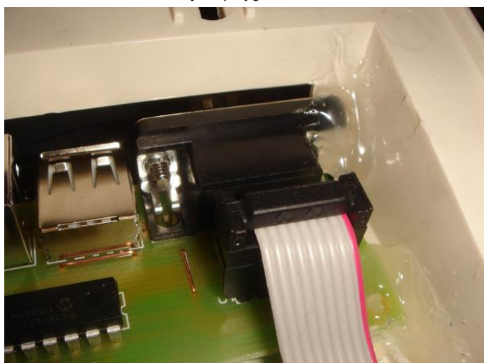
Mocowanie adaptera wewnątrz
