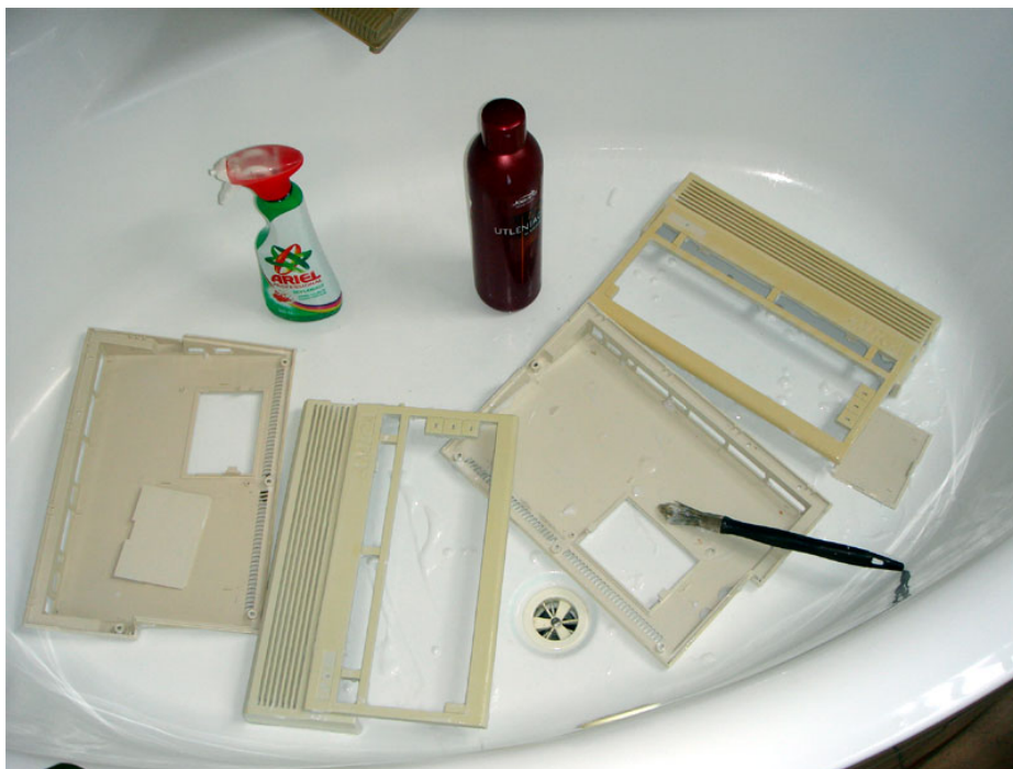
Sesja wybielająca. Z lewej Amiga 600 po kilku sesjach, na początku wyglądała jak jej koleżanka z prawej (po pierwszym nałożeniu).
