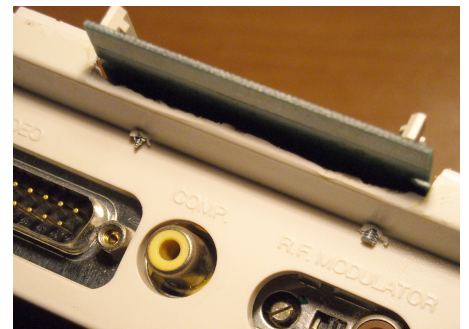
2. Czytnik IDE <-> CF w Amidze, widok od spodu obudowy A600
