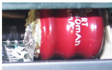
Na górze zdjęcie akumulatora RTC, na dole akumulator z wyciekiem elektrolitu
