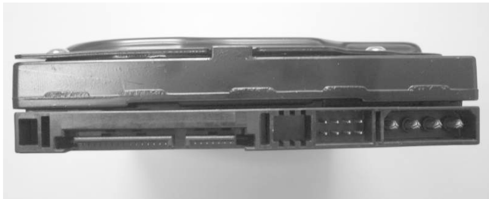
Dysk Western Digital SATA, którego użyłem do testów, posiada oprócz standardowego złącza zasilania PATA (czteropinowe gniazdo po prawej), piętnastopinowe gniazdo zasilania SATA (szereg pinów po lewej stronie). (UWAGA! dysk może być zasilany tylko z jednego źródła, albo zasilamy go przez złącze PATA, albo SATA. Podłączenie zasilania do obydwu gniazd spowoduje spalenie dysku! - przyp. tłum)
