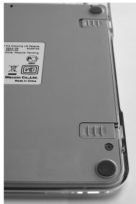
Zatrzaski pokazane powyżej utrzymują pokrywę na miejscu. Mogą być one łatwo odblokowane, co pozwala na szybki demontaż pokrywki.
