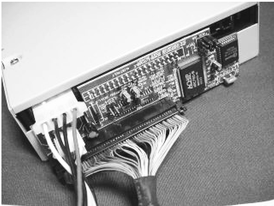
Prześciówka podłączona do typowego napędu optycznego IDE (CD/DVD). Zauważcie jak kształt płytki omija gniazda zasilania oraz wyjścia audio.
