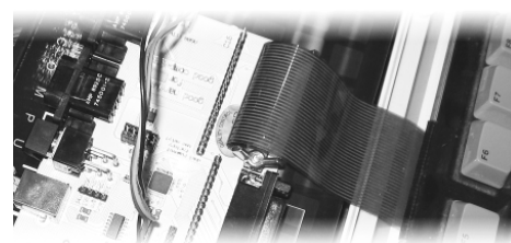
Zaskakująco pewne podłączenie klawiatury od Amigi 1200.
