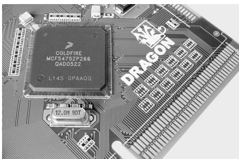
Procesor ColdFire 6475 266 MHz na karcie procesorowej Dragona
