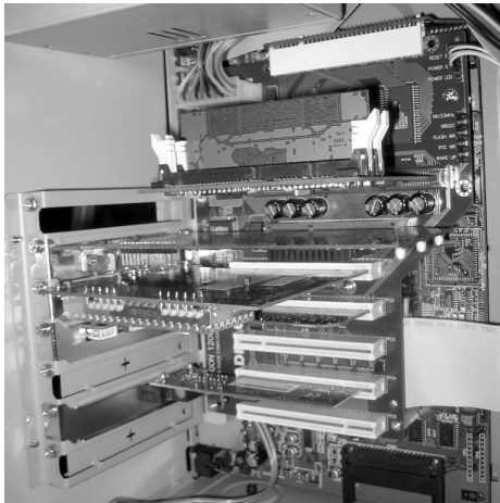
Karta Dragon zamontowana w obudowie D-Box wystawiana na Amizaduszkach 2006. W jego slotach zamontowano: kartę graficzną AGP, kartę telewizyjną PCI, interfejs USB Spider i kartę sieciową PCI. Zdjęcia: PPA.pl
